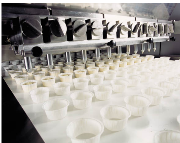
Fuente: Vertido de masa sobre cinta transportadora de la firma Franz Haas (Austria)
